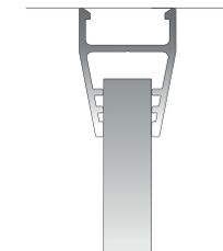
Profili congiunti fra loro ad incastro a formare un telaio portante, rigido e robusto.
