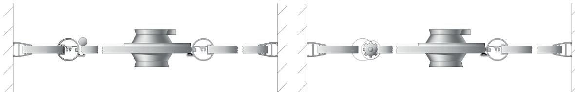
3 Sezione verticale con profilo superiore di irrigidimento
