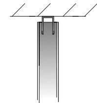
7 Raccordo a pavimento con profilo in alluminio all'interno del pannello
