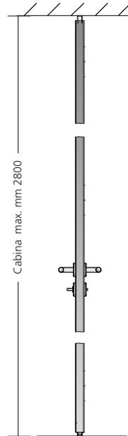
6 Raccordo a soffitto con profilo in alluminio all'interno del pannello
